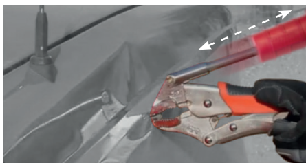
2- Movimiento de vaivén con el martillo de inercia.
